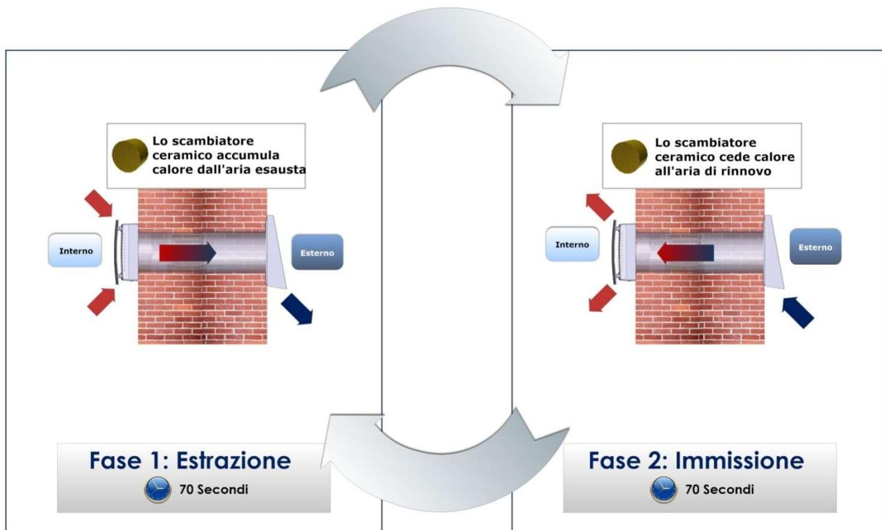
La macchina è provvista di un ventilatore con motore EC a recupero energetico, in grado di invertire il flusso di aria all'interno del recuperatore, funziona in due fasi:
