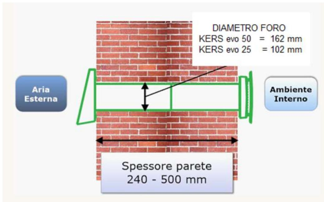
A Kers è possibile collegare un tratto rettilineo di tubazione di diametro nominale 160mm e lunghezza massima ammissibile di 3 metri
